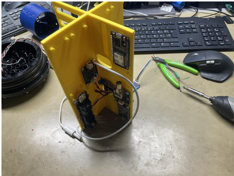
Joonis 14 Lõplik autonoomne seirejaam koostamise faasis
