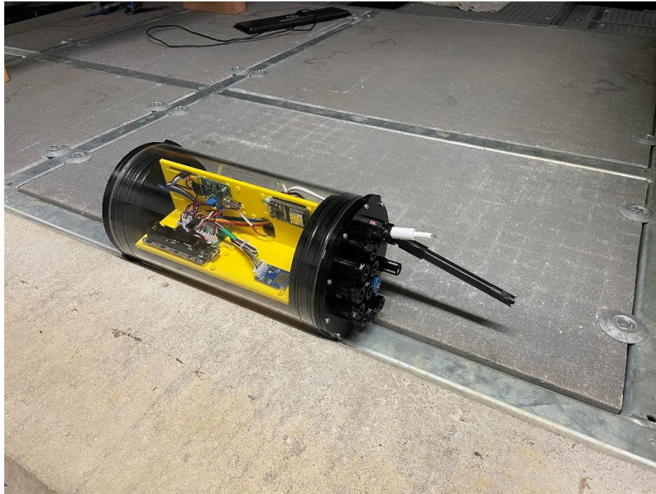
Joonis 15 Autonoomse seirejaama lõpliku lahendi kerge versioon
