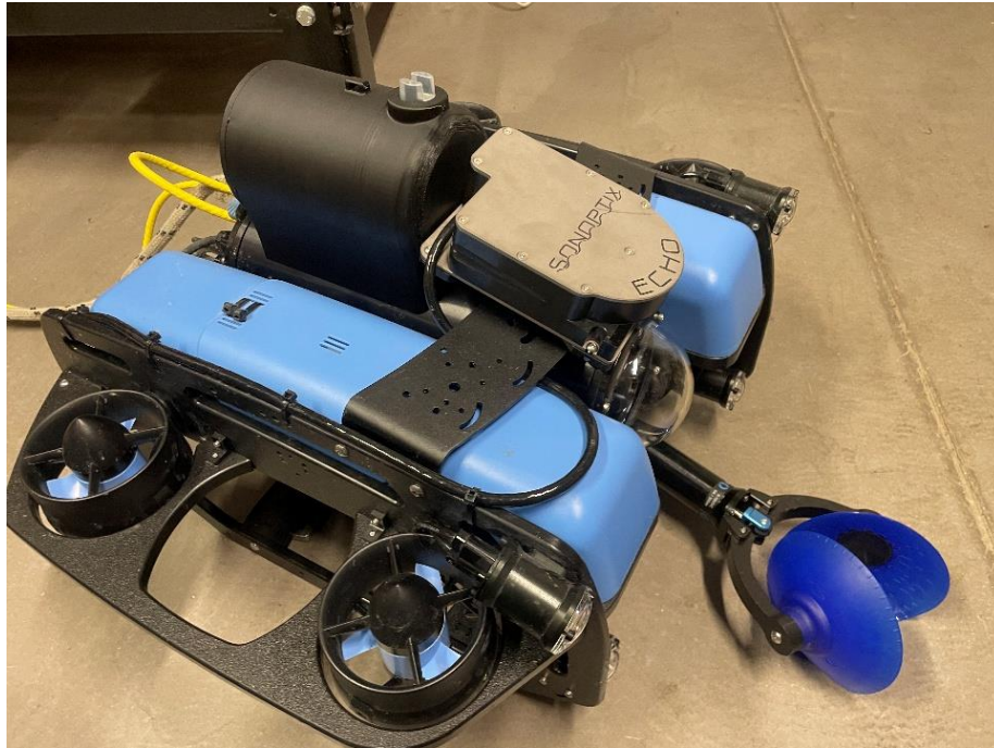
Joonis 13 Autonoomse seirejaama 1 iteratsioon integreerituna ROV lisamooduliks
