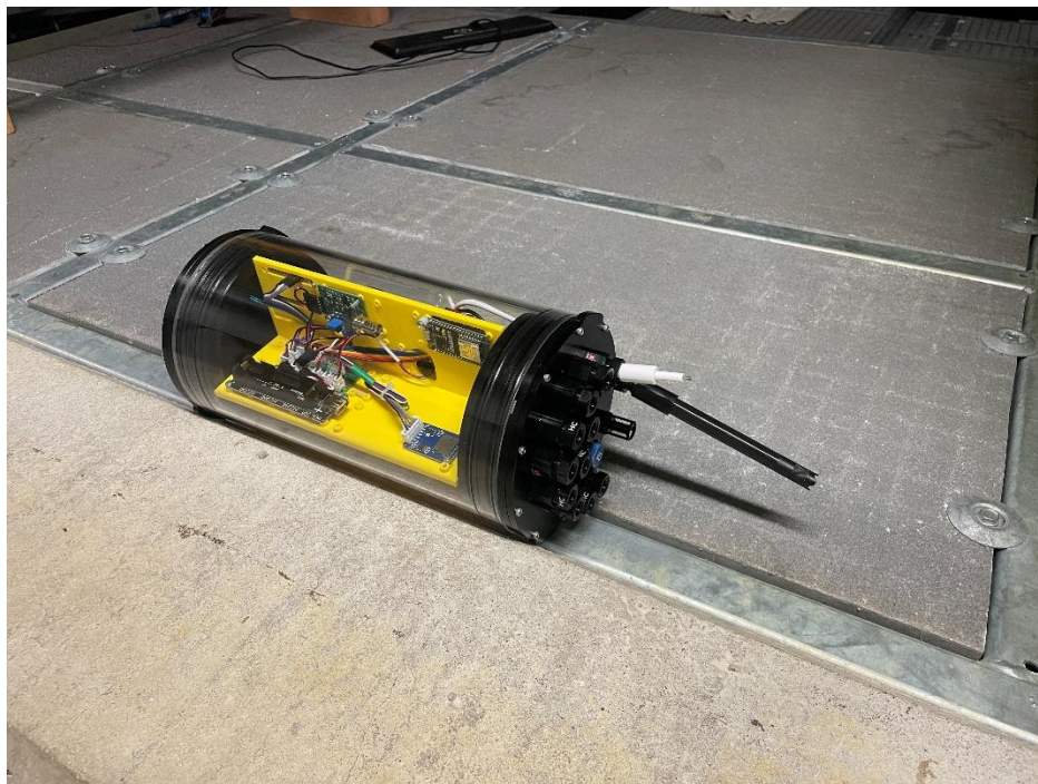
Joonis 15 Autonoomse seirejaama lõpliku lahendi kerge versioon
