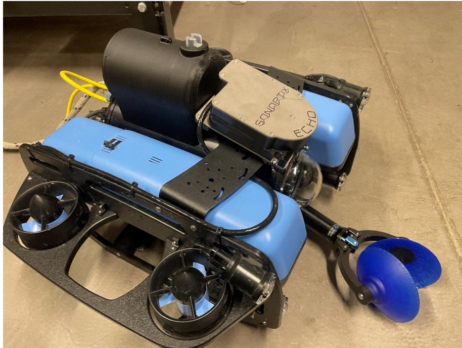
Joonis 13 Autonomse seirejaama 1 iteratsioon integreerituna ROV lisamooduliks
