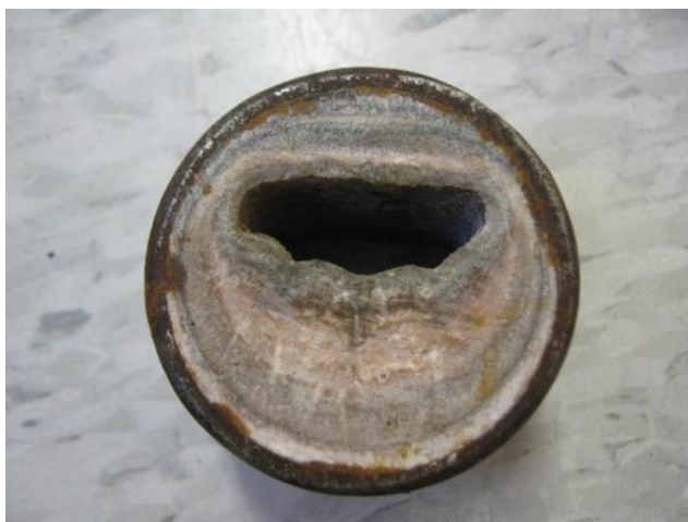
Joonis 4.1. Katlakiviga ummistunud toru [1]
