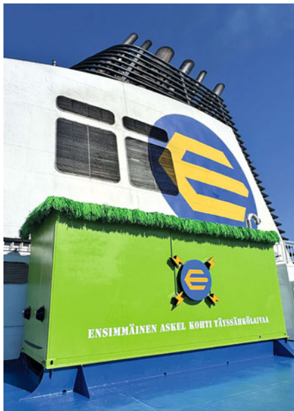
Reeder paigaldas tänavu talvel dokis olnud „Finlandia“ 9. tekile 1,4 MW akukonteineri. Selles on 93 akumoodulit, igaüks kaalub 100 kg. Fotol on akud näha konteineri sees ja väljastpoolt.
